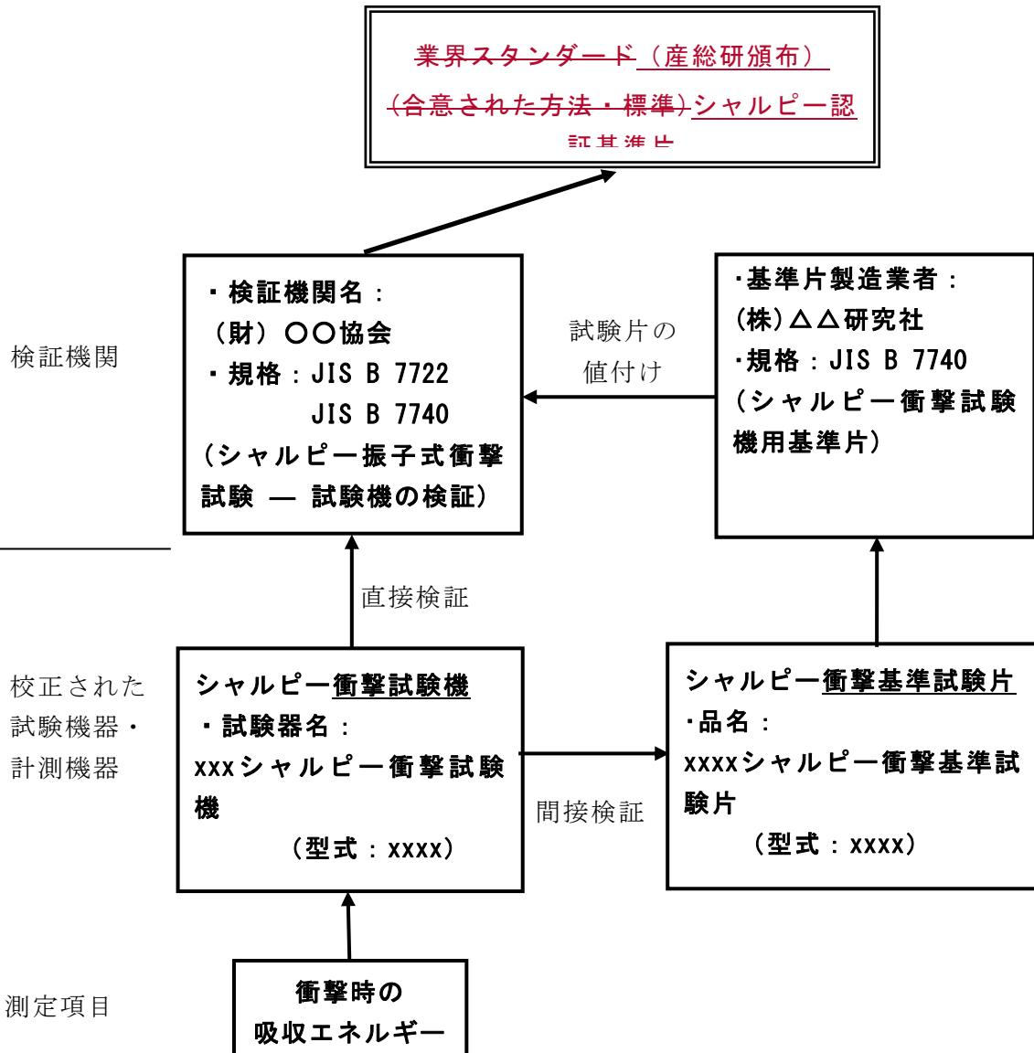
(参考) JIS B 7740により、検証機関の基準試験機は、国の標準値との比較（産総研依頼試験）により検証されている。
