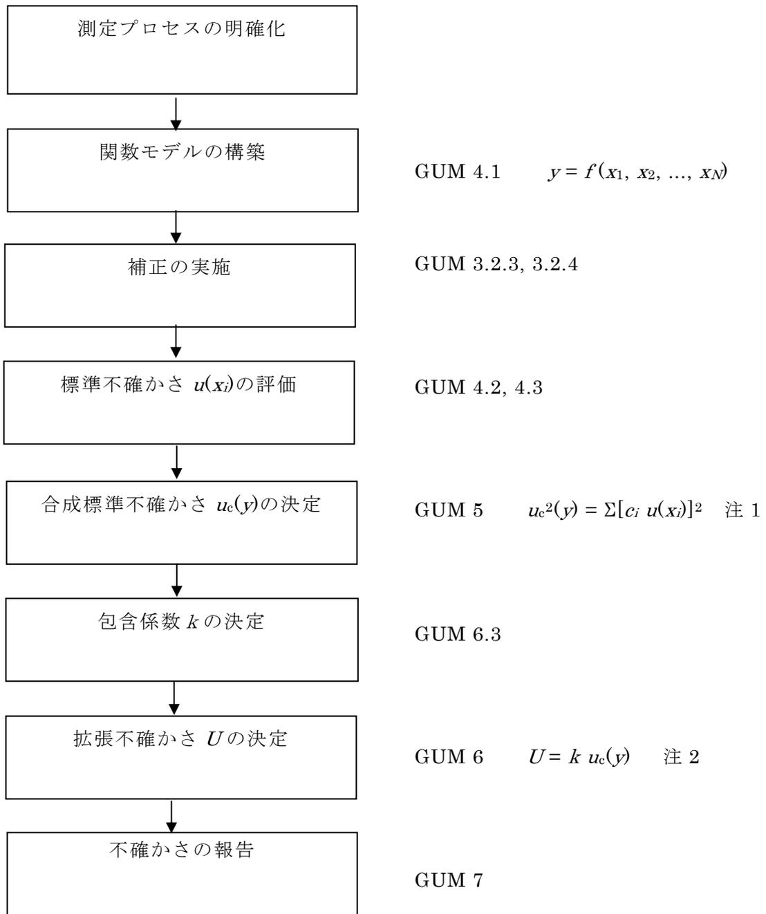
注 1 これは、入力量  $x_i$ 間に相関がない場合の式である。 $c_i$ は感度係数と呼ばれる量であり、 $c_i = \partial f / \partial x_i$ により計算される。
